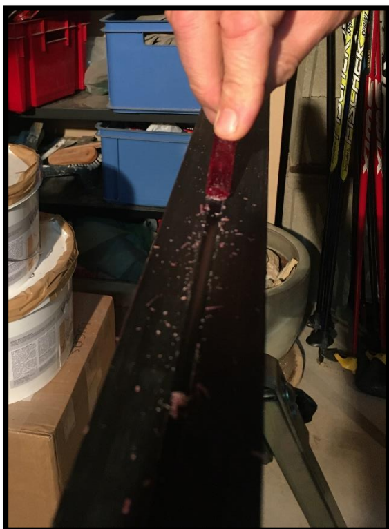
Dégager la (ou les) rainure(s) centrale(s) ...
